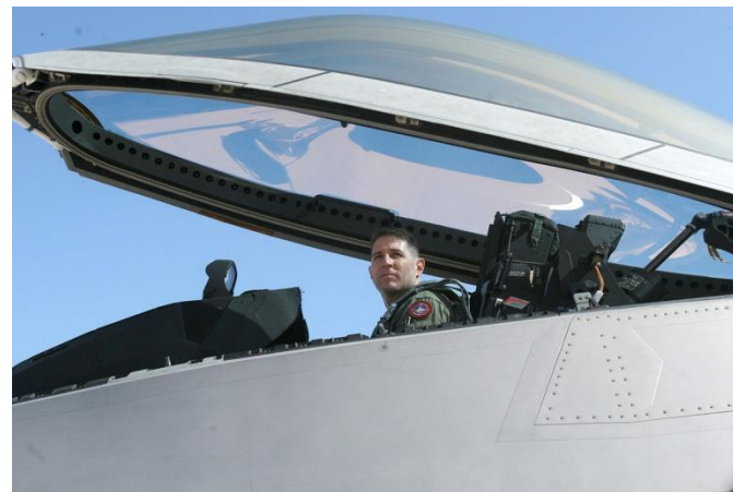
капак на пилотска кабина от поликарбонат
