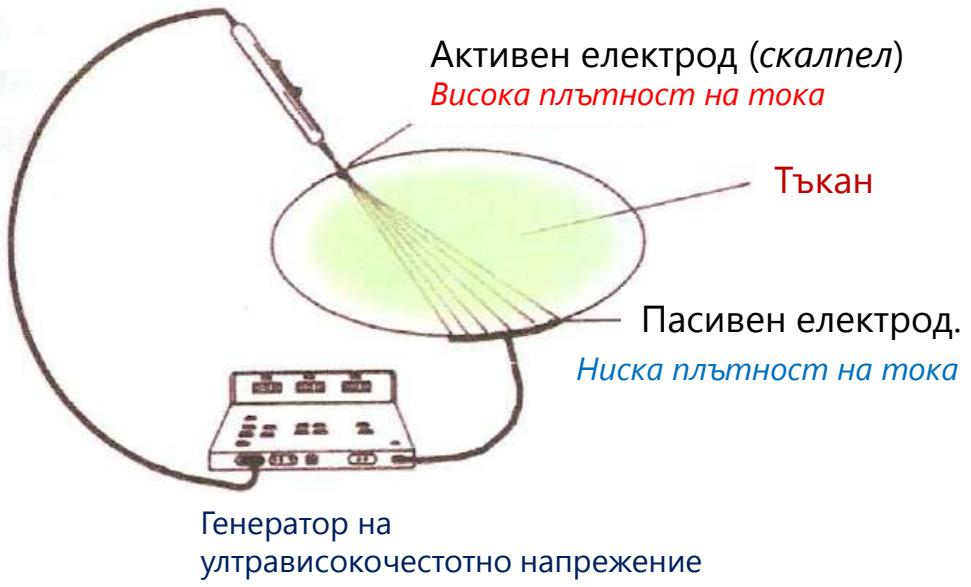
При монополярния режим напрежението се прилага между остър електрод (скалпел) и плосък с голяма площ, разположен дистално. При контакт на активния електрод (скалпела) с тъканта в близост до остието протича ток с висока плътност (до  $4 \text{ A/cm}^2$ ), който силно загрява тъканта и тя коагулира или се разрязва. Към "пасивния" електрод с голяма площ токът вече е с ниска плътност и няма тези разрушителни ефекти.
