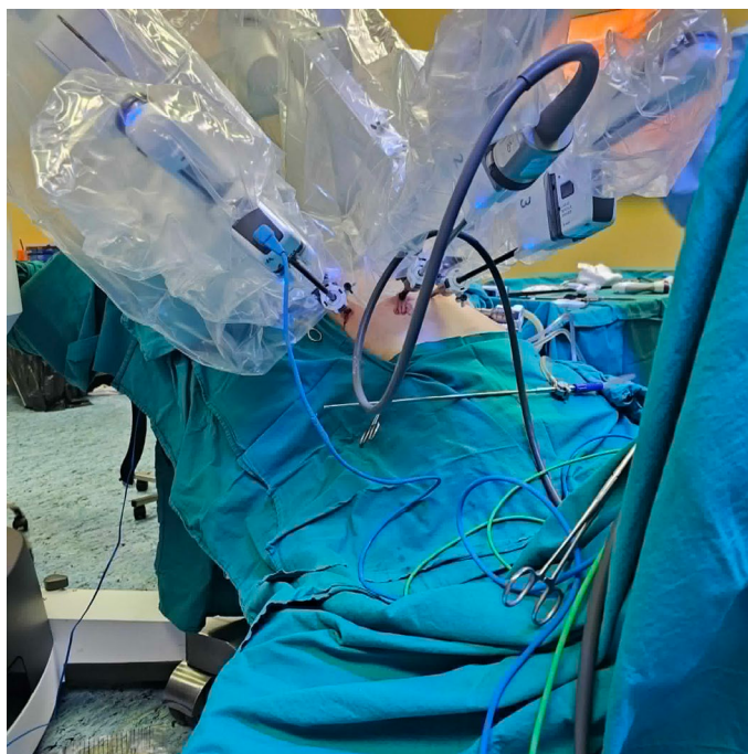
Фигура 4: Система за роботизирана хирургия Da Vinci X®.
